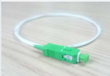
Dây dây nối quang có đường kính dây Ø0.9 mm
