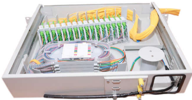
H1. Cáp vào được cố định chắc chắn ở phía sau của Module quang. Móc giữ cổ cáp và ốc giữ dây ra cường. Cho 3 cáp quang vào cùng lúc. Bên trong có các vòng dẫn, và lạt thít cố định ống đệm lỏng.
