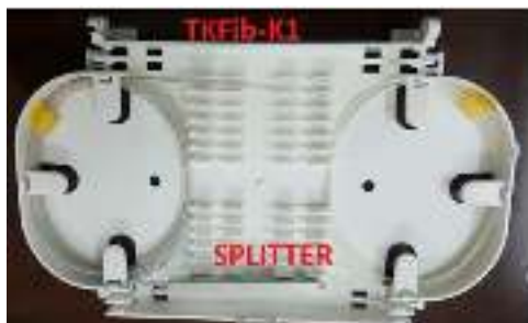
H1- Khay hàn quang TKFib-T dùng trong tủ hộp OTB, ODF
