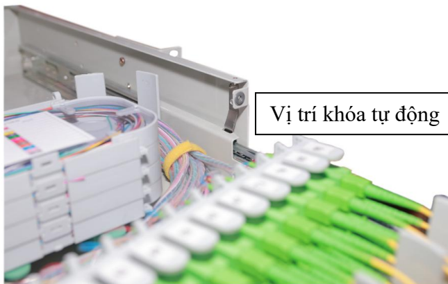
H5- Khi kéo lớp trượt bên trong ra hết. Sẽ có khóa tự động khóa lại an toàn.
