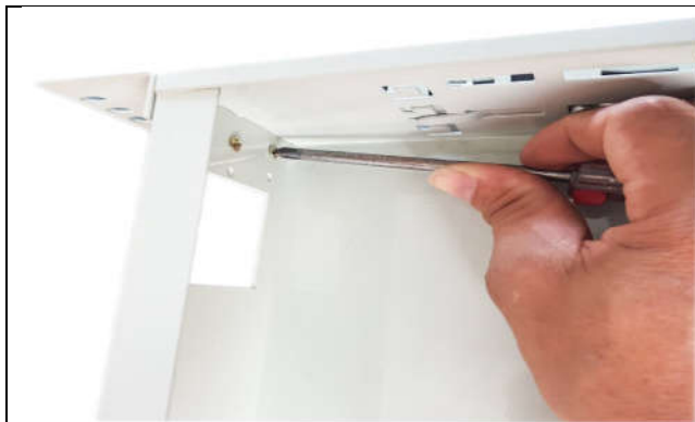
H1A . Gắn tai rack dài lên Module dùng tua vít bắt ốc từ trong ra. Tai này bắt vị trí cạnh sau cùng của Module để lắp lên tủ tập trung chuẩn 23”
