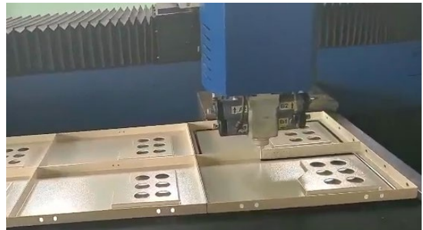
Máy đang thực hiện tạo gioăng lên nắp vỏ hộp
