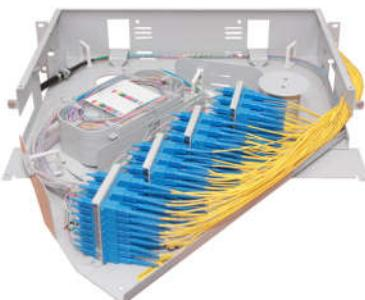
3.Cáp quang và dây nhảy quang ra bên phải đi theo sơ đồ như hình bó gọn bằng dây băng định. Cứ 2 Module ra đi gá vào 1 Rulo. Không được quấn tròn dây nhảy quanh Rulo. Khi gắn các Module hàn nối hay đấu nhảy quang từ trên xuống. Dây nhảy quang có thể đi ra đáy tủ hoặc trên nóc tủ
